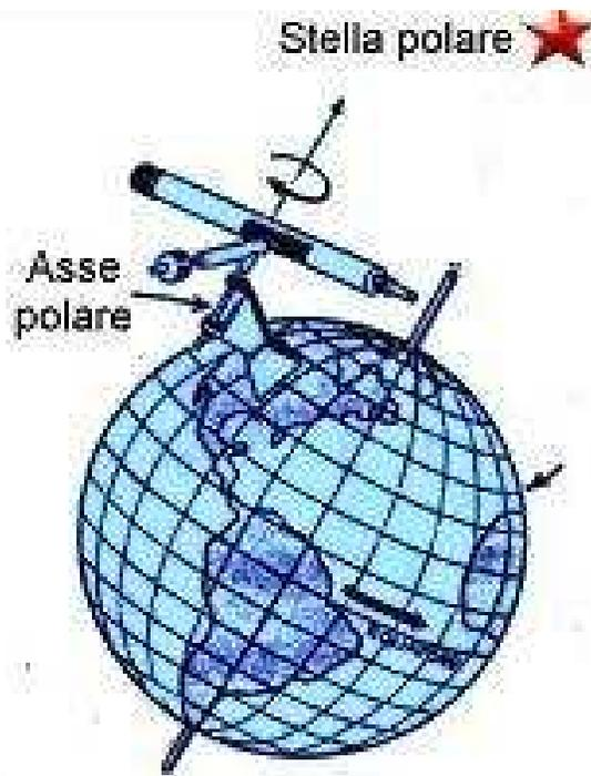
Figura 3.6: Montatura equatoriale di un telescopio.
