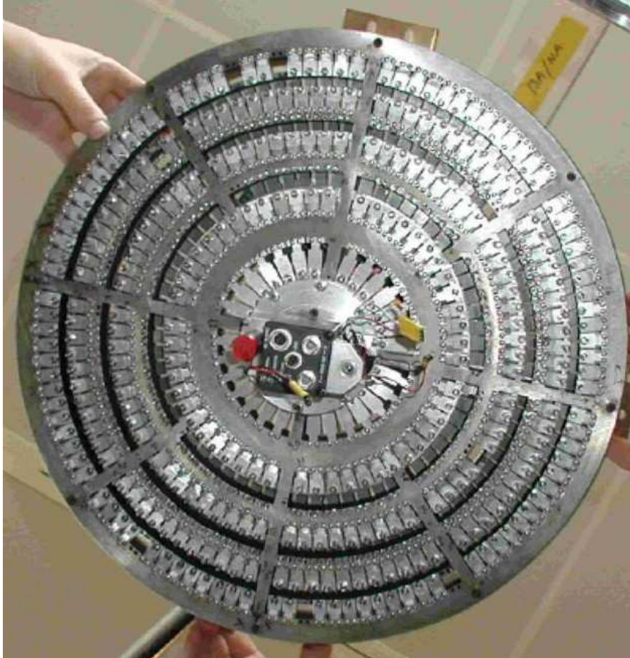
Figura 10.24: Foto di una lente di Laue realizzata per l'esperimento CLAIRE, consistente in 556 cristalli di Germanio Ge(111) montati su 8 anelli concentrici (si ringrazia Peter von Balmoos).
