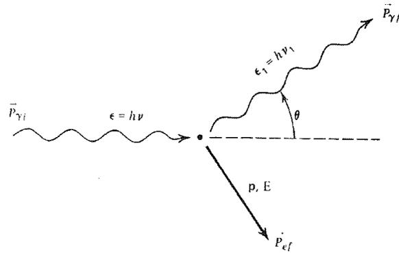
Figura 5.4: Definizione della geometria per un lo scattering di un fotone da parte di un elettrone inizialmente a riposo.
