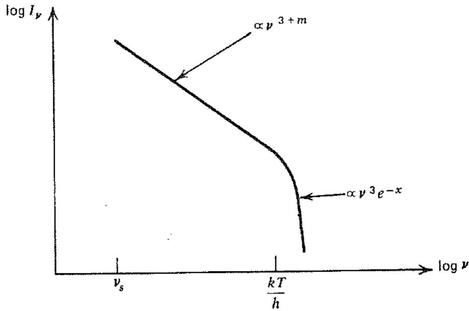
Figura 5.8: Spettro prodotto da Comptonizzazione non saturata di fotoni di bassa energia su elettroni termici.
