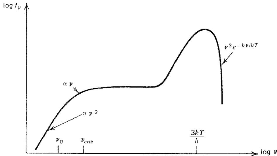
Figura 5.7: Spettro emergente da un mezzo termico, non relativistico caratterizzato da emissione ed assorbimento libero-libero e da scattering Compton inverso saturato. A basse frequenze lo spettro è un corpo nero, poi diventa un corpo nero modificato e ad alte frequenze diventa uno spettro di Wien.
