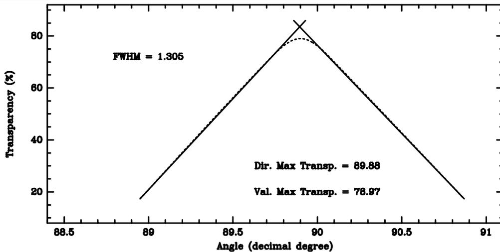
Figura 6.9: Funzione di trasmissione dei collimatori dell'esperimento di alta energia (15–200 keV) PDS a bordo del satellite BeppoSAX. Questi collimatori definiscono un campo di vista esagonale di  $1.3^\circ$  (FWHM).
