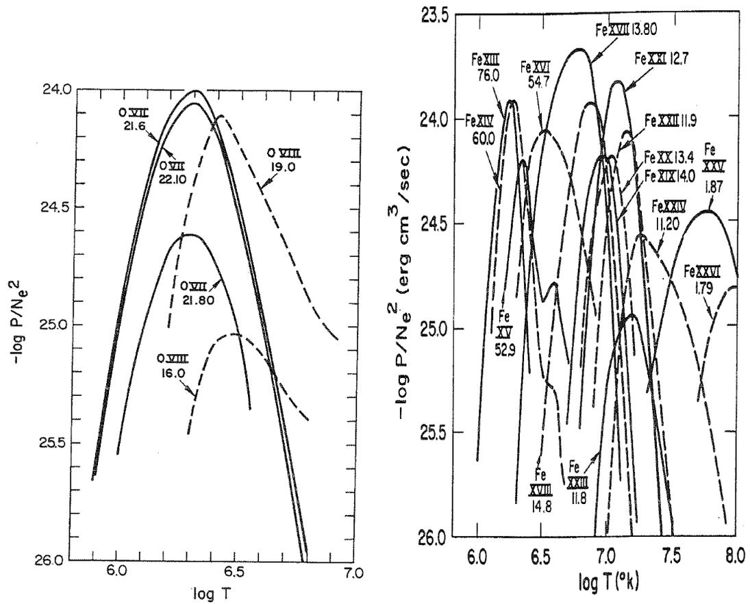
Figura 5.9: Intensità delle righe in funzione della temperatura per gli atomi di Carbonio e Ferro in diversi stati di ionizzazione.
