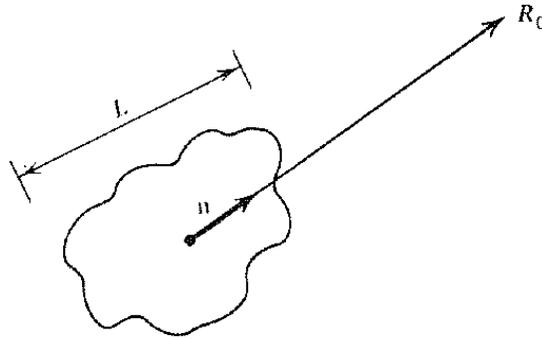
Figura 5.2: Campo di radiazione per un mezzo di dimensione  $L$ .
