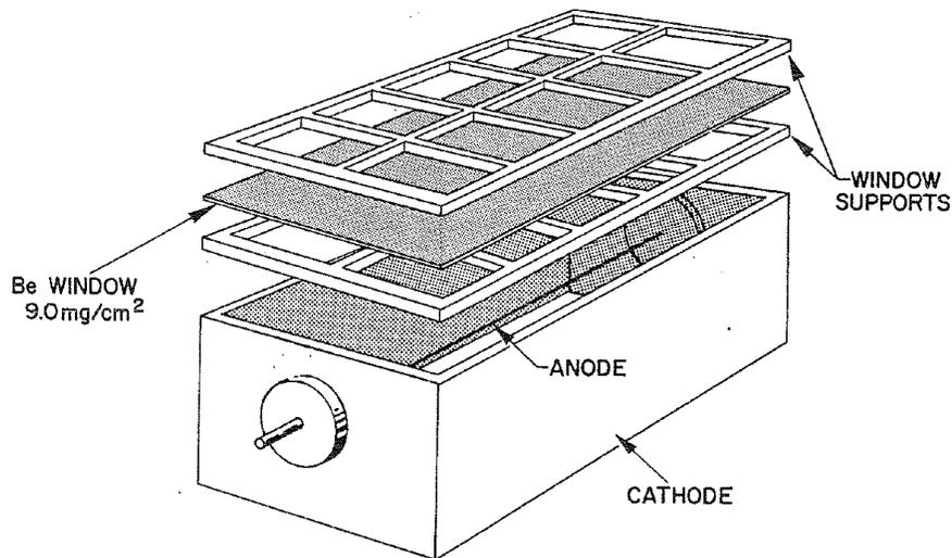
Figura 6.3: Configurazione tipica di un contatore proporzionale. La finestra di Berillio viene cementata in una struttura di supporto a *sandwich* che viene a sua volta saldata ermeticamente sul catodo per preservare l'integrità del gas. L'anodo viene tenuto in tensione da una molla. Un preamplificatore ed un generatore di alta tensione vengono montati il più vicino possibile all'ingresso dell'anodo.
