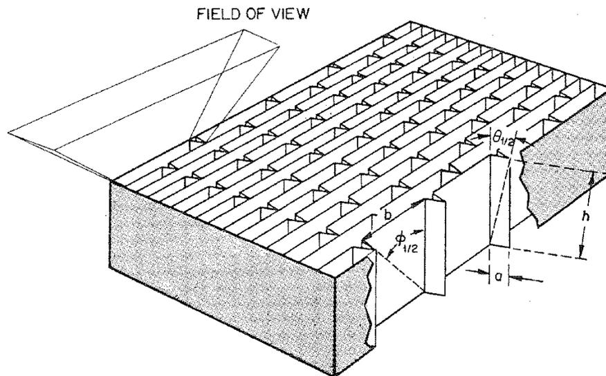
Figura 6.8: Un semplice collimatore formato da tubi rettangolari di altezza  $h$  e sezione  $a \times b$ . I raggi X che colpiscono le pareti dei tubi non possono raggiungere il rivelatore. La risposta all'interno il campo di vista avrà una forma triangolare in ognuna delle due direzioni ortogonali. Gli angoli per cui si ha solamente metà intensità trasmessa sono determinati dalla geometria:  $\tan \theta_{1/2} = a/h$  e  $\tan \phi_{1/2} = b/h$ .
