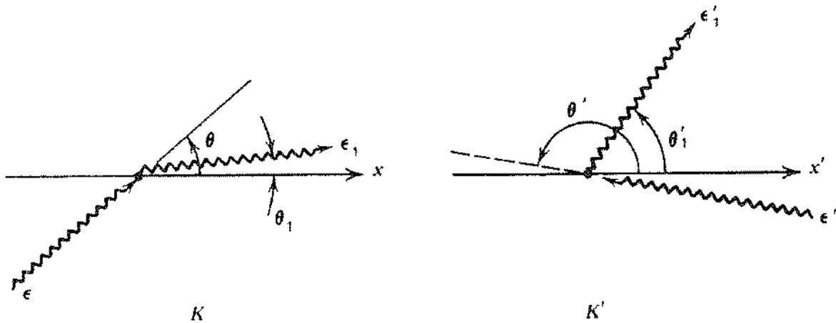
Figura 5.5: Definizione della geometria dello scattering Compton nel SdR  $K$  dell'osservatore e nel SdR  $K'$  dell'elettrone a riposo.
