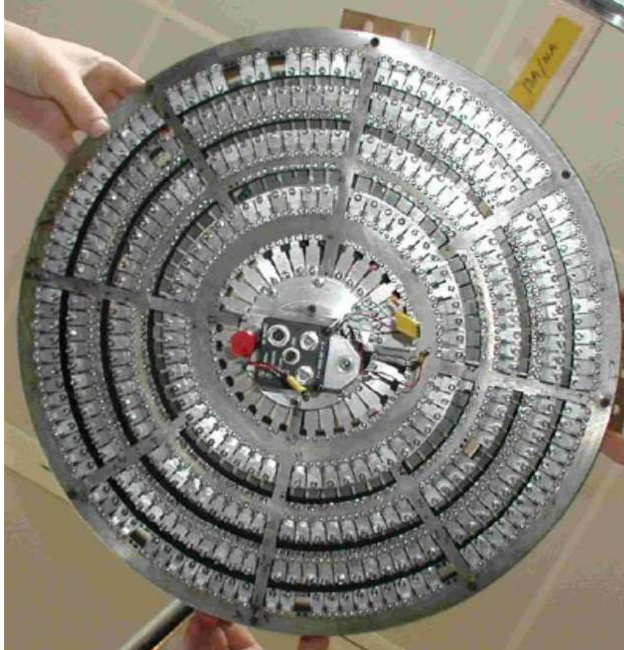
Figura 6.22: Foto di una lente di Laue realizzata per l'esperimento CLAIRE, consistente in 556 cristalli di Germanio Ge(111) montati su 8 anelli concentrici (si ringrazia Peter von Balmoos).
