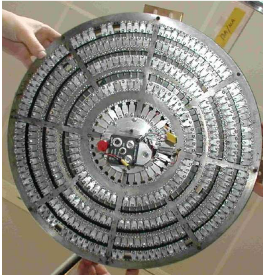
Figura 6.24: Foto di una lente di Laue realizzata per l'esperimento CLAIRE, consistente in 556 cristalli di Germanio Ge(111) montati su 8 anelli concentrici (si ringrazia Peter von Balmoos).
