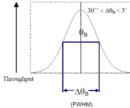
Figura 6.21: Definizione della mosaicità  $\Delta\theta_B$  di un cristallo.
