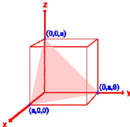
Figura 6.18: Definizione degli indici di Miller per l'orientamento dei piani reticolari di un cristallo. In figura è mostrato il piano (111).
