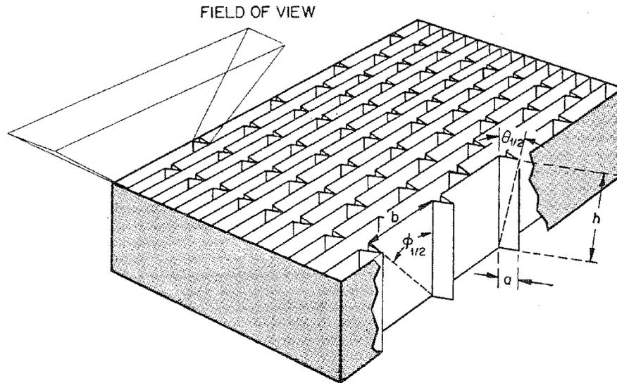
Figura 6.9: Un semplice collimatore formato da tubi rettangolari di altezza  $h$  e sezione  $a \times b$ . I raggi X che colpiscono le pareti dei tubi non possono raggiungere il rivelatore. La risposta all'interno il campo di vista avrà una forma triangolare in ognuna delle due direzioni ortogonali. Gli angoli per cui si ha solamente metà intensità trasmessa sono determinati dalla geometria:  $\tan \theta_{1/2} = a/h$  e  $\tan \phi_{1/2} = b/h$ .
