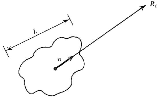
Figura 5.1: Campo di radiazione per un mezzo di dimensione  $L$ .
