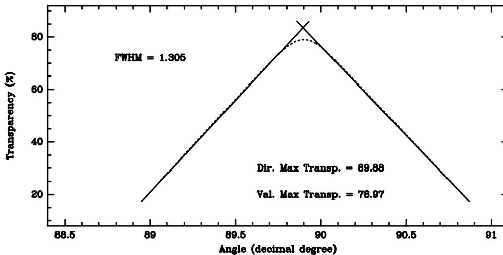
Figura 6.10: Funzione di trasmissione dei collimatori dell'esperimento di alta energia (15–200 keV) PDS a bordo del satellite BeppoSAX. Questi collimatori definiscono un campo di vista esagonale di  $1.3^\circ$  (FWHM).
