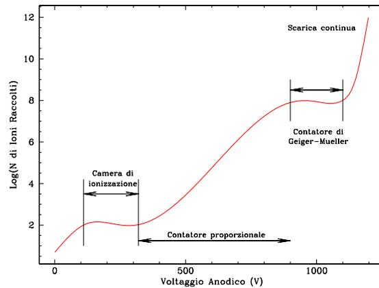
Figura 6.2: Output di un rivelatore a gas in funzione del voltaggio applicato all'anodo. Si tenga presente che i valori esatti dell'alta tensione variano moltissimo in funzione della geometria del rivelatore, del tipo e della pressione del gas utilizzato.
