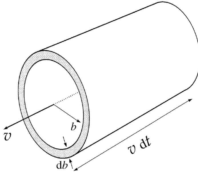
Figura 4.2: Definizione della geometria nel caso urti Coulombiani di una particella di plasma di velocità  $v$ .
