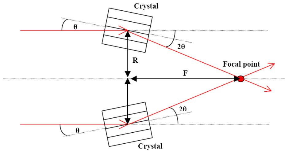
Figura 6.22: Principio di funzionamento di una lente di Laue: i cristalli sono posizionati su di un anello di raggio  $R$ , hanno tutti lo stesso orientamento  $\theta$  e focalizzano fotoni di una certa energia ad una distanza focale  $F$ .
