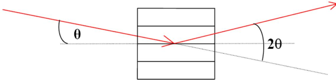
Figura 6.17: Geometria della diffrazione di Laue: un raggio di alta energia attraversa un cristallo e subisce diffrazione di Bragg sui piani cristallini, emergendo con un angolo pari a  $\theta$ .
