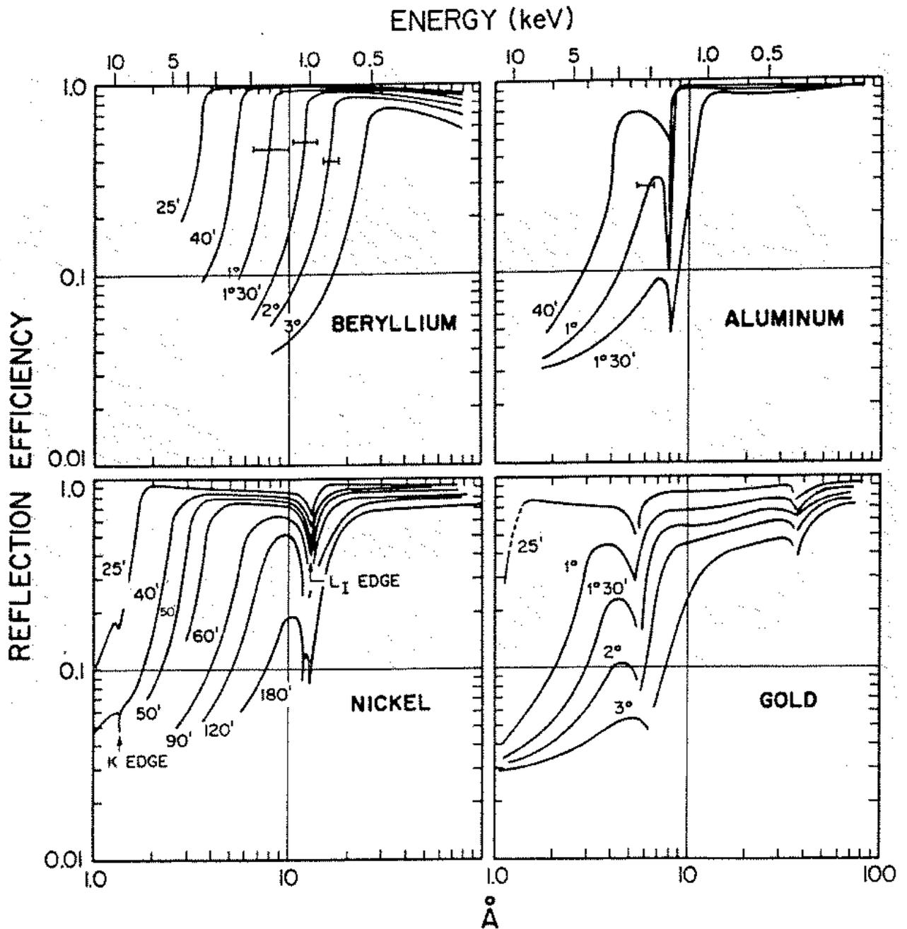
Figura 6.12: Efficienze di riflessione teoriche superficiali in funzione dell'energia (scala superiore) o della lunghezza d'onda (scala inferiore) per diversi angoli di incidenza radente e per diversi materiali: Be ( $Z = 4$ ), Al ( $Z = 13$ ), Ni ( $Z = 28$ ) e Au ( $Z = 79$ ). L'angolo critico per ogni energia può essere definito come quell'angolo a cui la riflettività diminuisce di un certo valore, per esempio 10%. La complessità delle curve è dovuta ad effetti negli edge di assorbimento.
