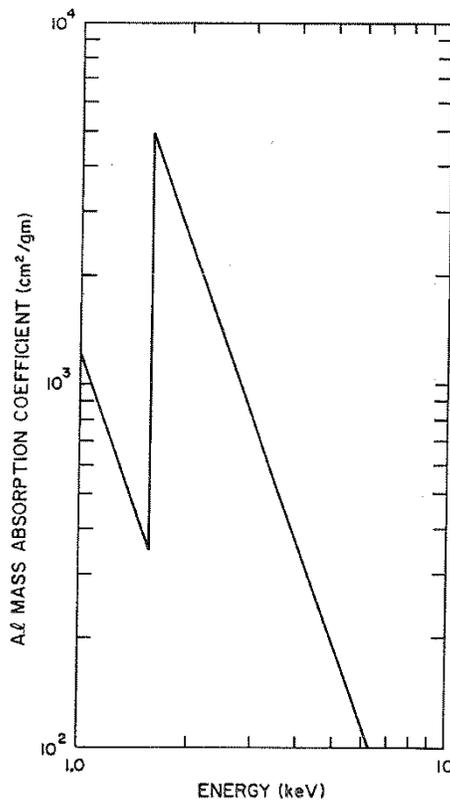
Figura 6.3: Coefficiente di assorbimento per unità di massa per l'Alluminio. Nell'intervallo di energia mostrato, tutto l'assorbimento è dovuto ad effetto fotoelettrico. L'assorbimento mostra una discontinuità a 1.56 keV perché un fotone X di maggiore energia può espellere un elettrone della shell K.
